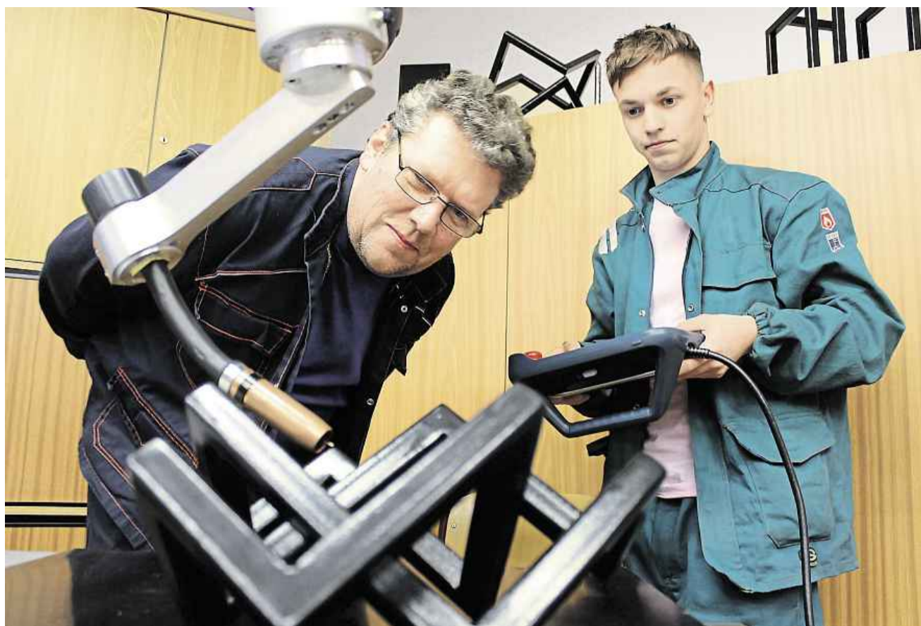
PŘÍPRAVA PŘED SVAŘOVÁNÍM BUDOUCÍ MECHANIK MILOŠ VANĚK SE POKOUŠÍ NAVÉST ROBOTA NA PŘESNÉ MÍSTO, KDE BY MĚL SVAŘOVAT.
